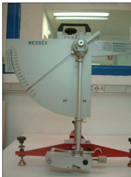
Detailansicht des Pendelreibungsprüfgeräts
